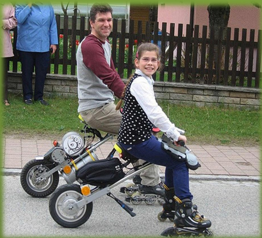
속도는 최대 40km미터가 나며 36볼트 배터리와 500 와트 모터로 이루어져 있습니다. 무게는 24kg인데 내년에 어른용, 청소년용, 아동용으로 출시 될 예정입 니다-독일 FlyRad unicycle
